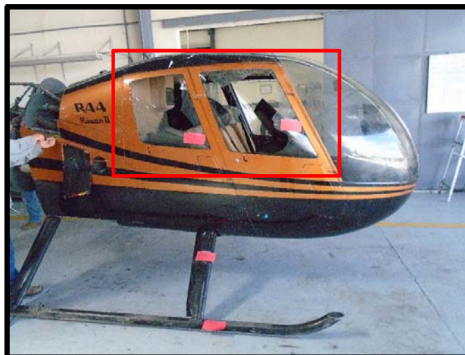
Fotografía No. 10 Daño por fractura en las ventanas rotas aeronave.
