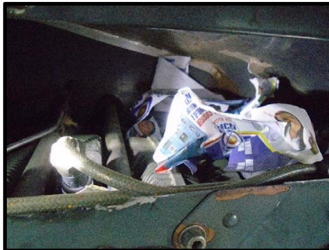
Fotografía No. 14 Vista superior del motor con papeles de propaganda sobre los cilindros.
